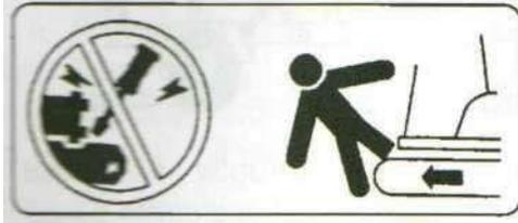
Asegúrese de que la pala está en el lado «-0»\*. (La pala debe estar en posición -2). Si el bastidor giratorio ha girado 180°, es decir, si la pala se encuentra, vista desde el operador, «detrás», entonces la dirección de desplazamiento es opuesta a la dirección de conducción de las palancas (al activar la palanca de conducción hacia delante, la excavadora, vista desde el operador, se moverá hacia atrás).
